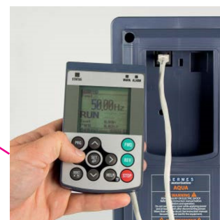
afficheur déportable - intégration en façade de porte - fonction copier/coller
