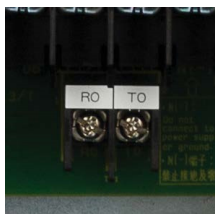
alimentation auxiliaire (idéal en communication bus, pour maintenir la carte contrôle sous tensions en cas de perte d'alimentation principale)
