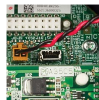
port mini USB type B pour connexion PC
